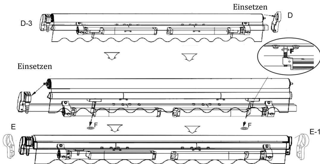
2. Einstellen der Position der gesamten Markise. Stellen Sie sicher, dass zwei Arme fest am Drehstab befestigt sind, und bewegen Sie die vordere Lenkergelenkstütze (Q), bis sie mit dem vorderen Lenkergelenk verbunden ist. Richten Sie die vordere Lenker und die Walze aus und ziehen Sie die Schraube (Q) der beiden vorderen Lenkergelenkstützen fest mit einem Schraubendreher nach oben. Ziehen Sie diese Schrauben nicht fest an. Lassen Sie 4 mm Platz für die Schrauben.
