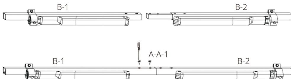
Linker Walzenträger mit Getriebebaugruppe Hämmern Sie den linken Walzenträger mit Getriebe in den Drehstab mit sanfter Kraft. Ziehen Sie die Schraube mit Schraubendreher fest.
