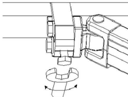
Hinweis: Die Markise wird bereits mit einem optimal eingestellten Neigungswinkel ausgeliefert. Der Benutzer kann den Bildschirmwinkel jedoch in einem Bereich von 5 ° bis 40 ° einstellen, wie in der Abbildung gezeigt:
